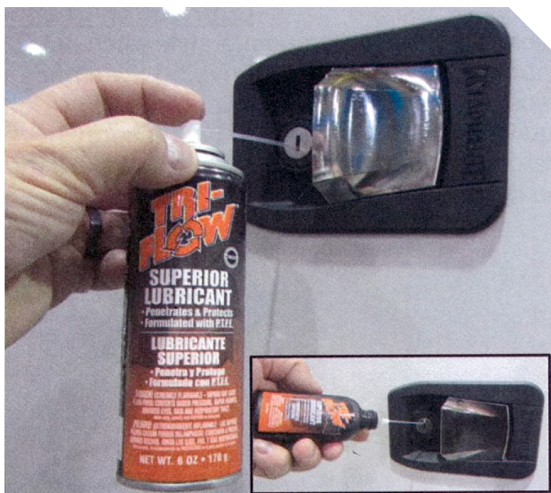
D. Lubricate Door Lock Cylinders
